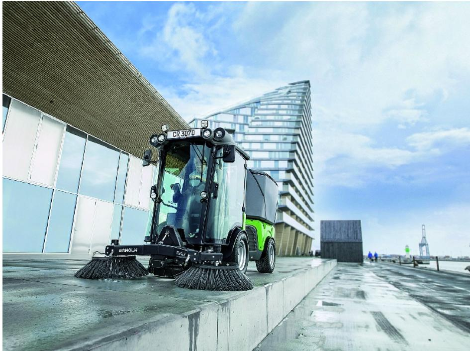
Egholm stellt eine neue semikompakte Maschine mit neuem innovativen Kehrsystem vor: Den City Ranger 3070. Mit einem Gesamtgewicht von 3 t und einer Motorleistung von etwa 70 PS wird er in vielen Bereichen als starker Konkurrent in dieser Maschinenklasse bis 1 m<sup>3</sup> Kehrgutbehälter auftreten.
