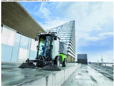
Egholm stellt eine neue semikompakte Maschine mit neuem innovativen Kehrsystem vor: Den City Ranger 3070. Mit einem Gesamtgewicht von 3 t und einer Motorleistung von etwa 70 PS wird er in vielen Bereichen als starker Konkurrent in dieser Maschinenklasse bis 1 m³ Kehrgutbehälter auftreten.
