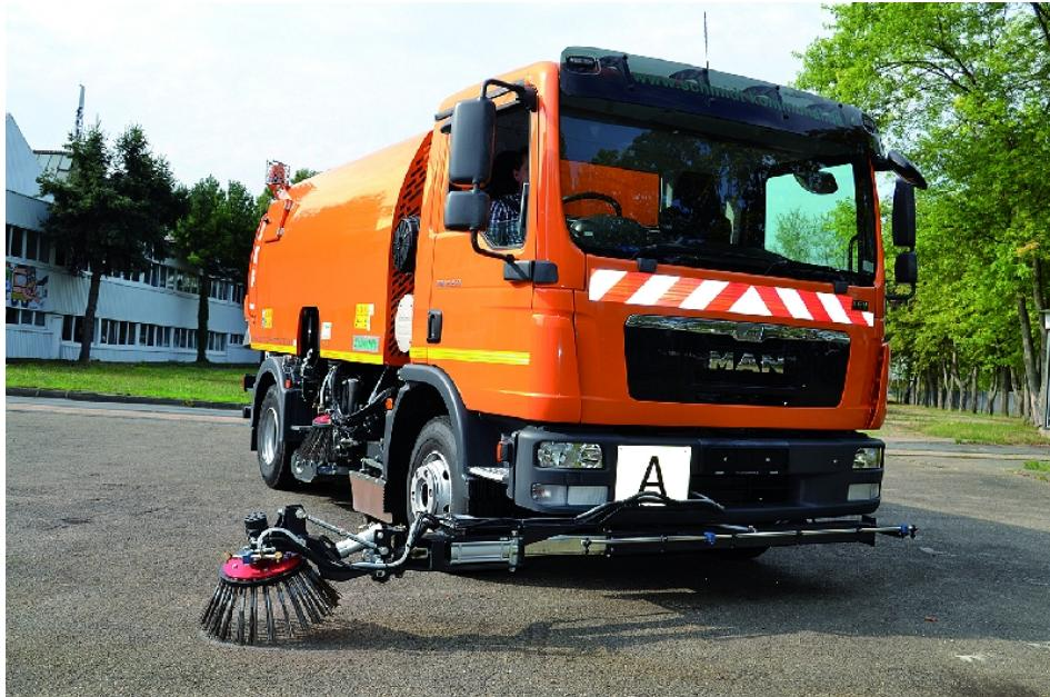
Zwei Kehraufbauten für Lkw-Fahrgestelle hat Schmidt Kommunalfahrzeuge in Groß-Rohrheim im Programm – mit 4 oder 7 m<sup>3</sup> Behältervolumen.
