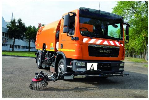
Zwei Kehraufbauten für Lkw-Fahrgestelle hat Schmidt Kommunalfahrzeuge in Groß-Rohrheim im Programm – mit 4 oder 7  $\rm m^3$  Behältervolumen.
