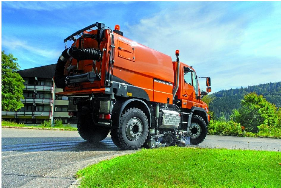
Die SK 350 von Aebi Schmidt ist eine Wechselaufbau-Kehrmaschine für Unimog-Fahrgestelle.
