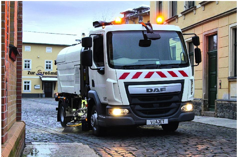
Statt einer großen Kompaktkehrmaschine ein kleiner Lkw-Kehraufbau Faun Viajet 4.
