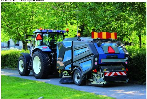
Die Anhängerkehrmaschine Wasa 300+ (Aebi Schmidt) kehrt auf einer Breite von 2400 mm und sammelt das Kehrgut in einem 3 m³ großen Behälter.
