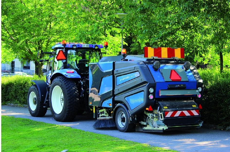
Die Anhängerkehrmaschine Wasa 300+ (Aebi Schmidt) kehrt auf einer Breite von 2400 mm und sammelt das Kehrgut in einem 3 m<sup>3</sup> großen Behälter.
