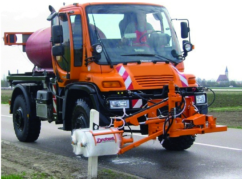
Ein Unimog mit Drutzel Leitpfostenwaschgerät LWG-U-300.
