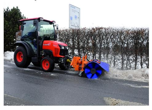
Frontkehrmaschine FKMZ 1310 mit mechanischem Zapfwellenantrieb und Winterbürsteneinsatz (Fiedler).
