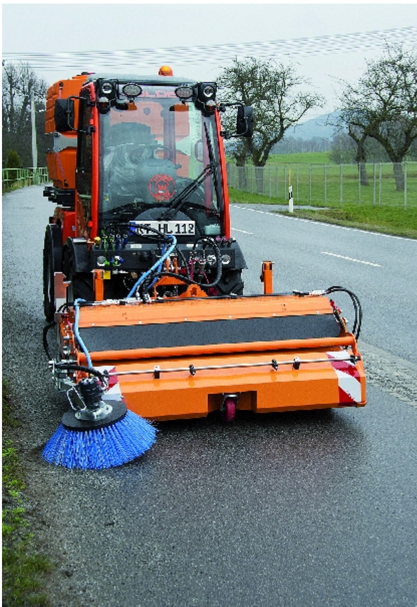
Frontkehrmaschine Fiedler FFK 1610 mit Seitenbesen und optionaler Wassersprengereinrichtung.
