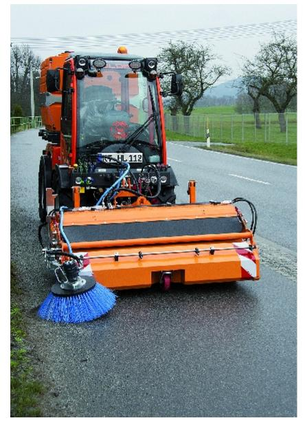
Frontkehrmaschine Fiedler FFK 1610 mit Seitenbesen und optionaler Wassersprengeinrichtung.
