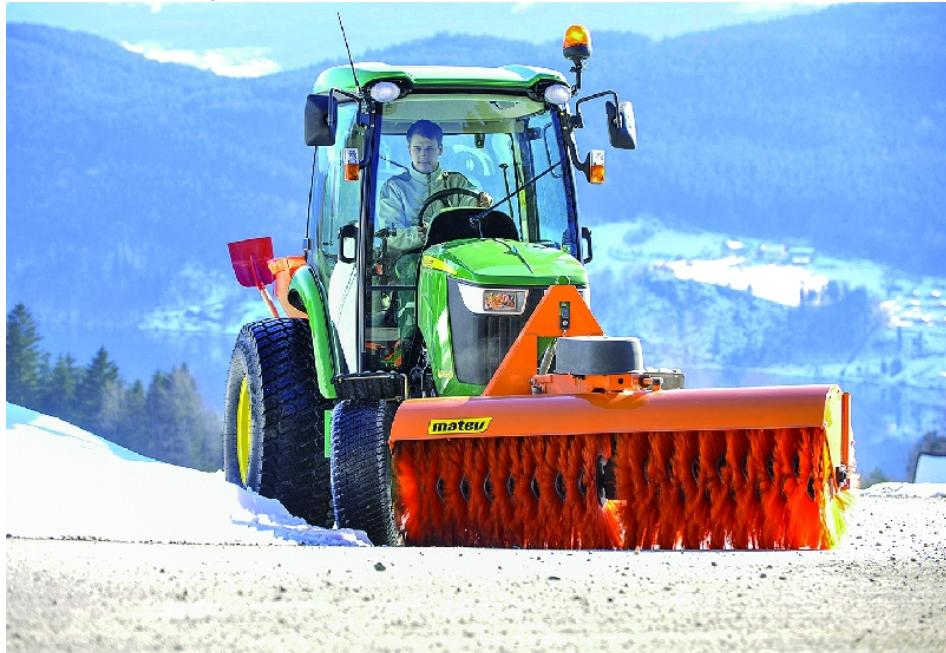
Die serienmäßige hydraulische Winkelverstellung der Kehrwalzen verbessert die Möglichkeiten zur Anpassung an die unterschiedlichsten Bedingungen (matev).
