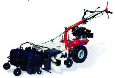
Die eurosystems M 250 EVO in der Konfiguration als Kehrmaschine.
