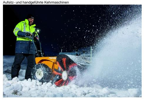
Leise räumen: Mit der akkubetriebenen Kehrmaschine Cleanion klappt das auch in lärmsensiblen Bereichen und für ca. fünf Stunden Einsatzzeit.
