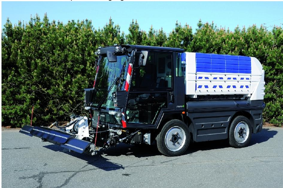
Der Cityjet 3030 SW ist ein Hochleistungs-Schwemmfahrzeug auf Basis der bewährten Swingo 200+ Baureihe.
