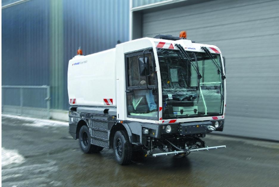
Zur Reinigung von besonders verschmutzten Flächen und größeren Verkehrsflächen hat Aebi Schmidt das Modell Cityjet 6000 im Programm.
