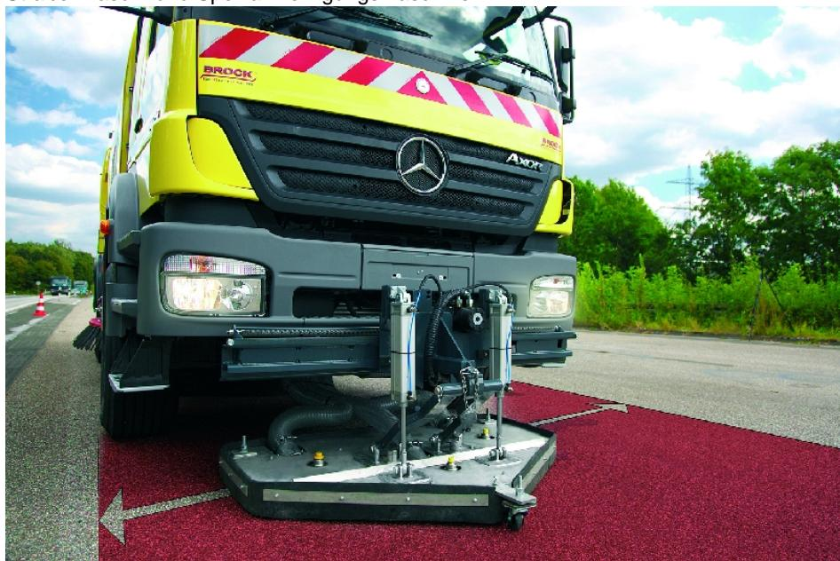
Die Ölspurbeseitigungseinheit SL 280 der Firma Brock lässt sich an allen Kehrfahrzeugen anbauen. Praktisch: Dank Parallellaufschiene ist eine Reinigung auf der kompletten Fahrzeugbreite möglich.
