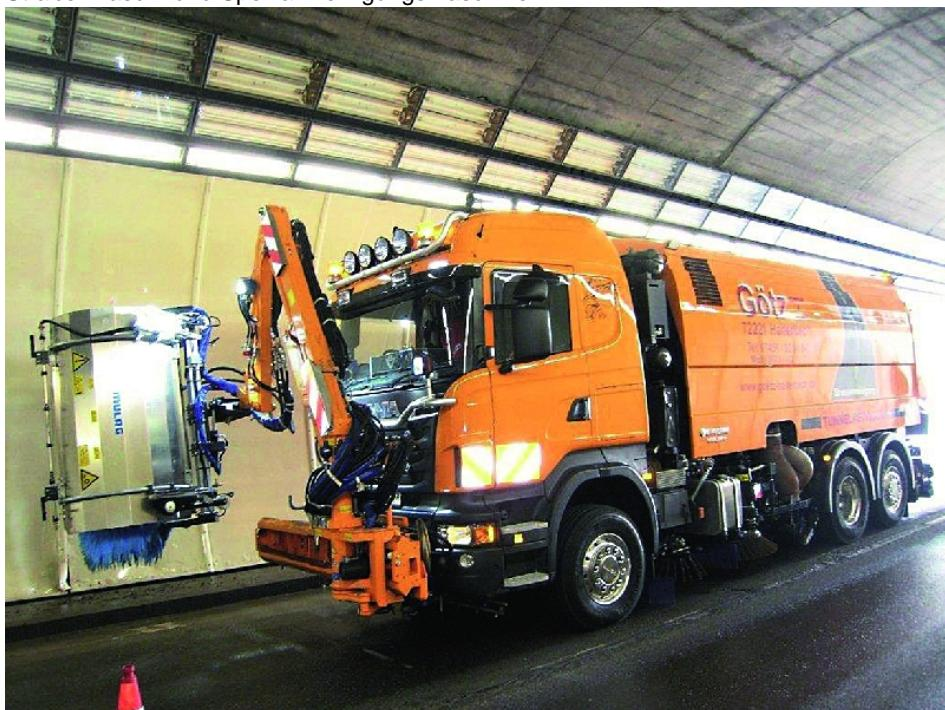
Mit ihrer beheizbaren Hochdruck-Sprühhanlage ist die Viajet 12 Aquatherm ein Spezialist für Fräsguteinsätze, die Ölspurbeseitigung sowie die Reinigung von Tunnelwänden (Faun).
