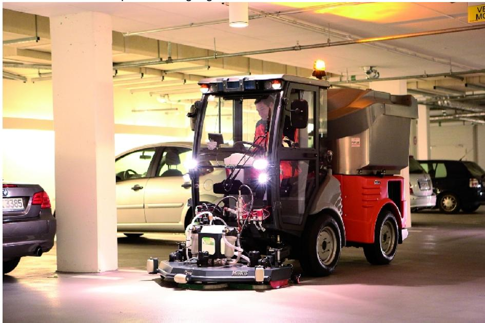
Nassreinigung mit dem Citymaster 1250 CityCleaner. Die Maschine in Verbindung mit speziell ausgelegten Reinigungsmitteln auch zur Ölspurbeseitigung (Hako).
