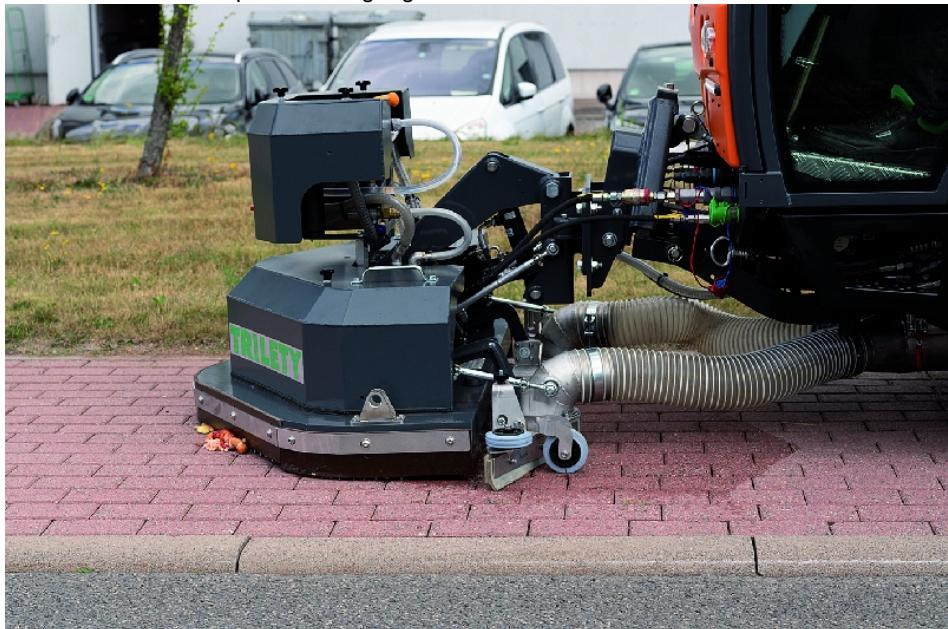
Trilety TSW 2 Bodenschrubber mit Wasseranlage und drei hydraulisch angetriebenen Tellerbürsten.
