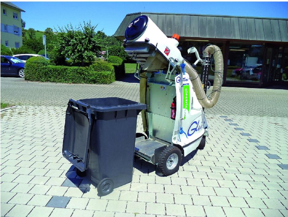
Eine 240-l-Mülltonne dient als Schmutzbehälter und kann ebenfalls mit einem Kunststoff sack bestückt werden.
