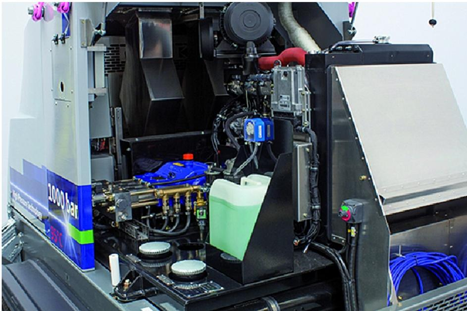
Das Uraca-Hochdruck-Reinigungsaggregat JetPower ist besonders für Oberflächen geeignet, bei denen mit Heißwasser effektiv und schonend zugleich gereinigt werden soll.
