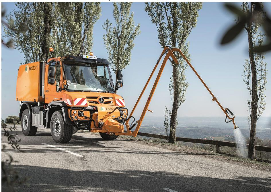
Den Gießarm von Eco Technologies gibt es für verschiedene Trägerfahrzeuge. Der Wassertank befindet sich entweder auf einer Pritsche oder wird per Dreipunktanbau am Heck befestigt.
