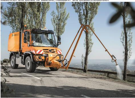
Den Gießarm von Eco Technologies gibt es für verschiedene Trägerfahrzeuge. Der Wassertank befindet sich entweder auf einer Pritsche oder wird per Dreipunktanbau am Heck befestigt.
