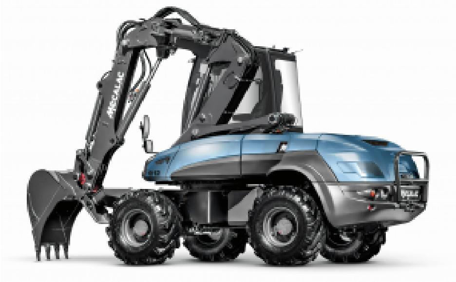
Die LiFe-PO4-Batteriegruppe des Elektrobaggers verbindet eine deutlich längere Lebensdauer als herkömmliche Batterien mit absoluter Sicherheit: keine Brandgefahr und kein Auslaufen der Batterieflüssigkeit.
