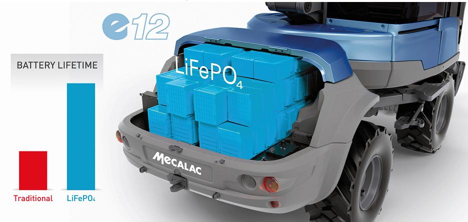
Der knickgelenkte Mecalac e12 steht für starke Leistung und Beweglichkeit auf städtischen Baustellen. Die vom Oberwagen getrennte Energiequelle ermöglicht eine Leistungsinstallation von 146 kWh und bietet damit eine Laufzeit von 8 Stunden.
