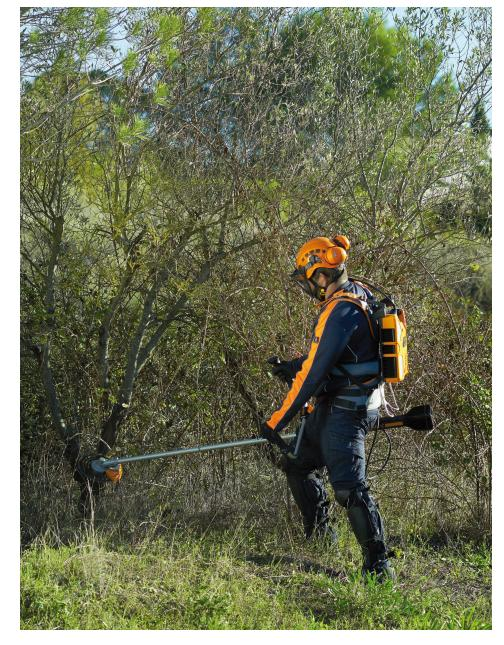
Dieses neue Alpha-Rückengurtzeug kann die neuen Akkus 260 und 520 für alle Geräte der Pellenc-Produktreihe aufnehmen. Besonderes Augenmerk haben die Ingenieure auf Ergonomie und Bedienkomfort gelegt.
