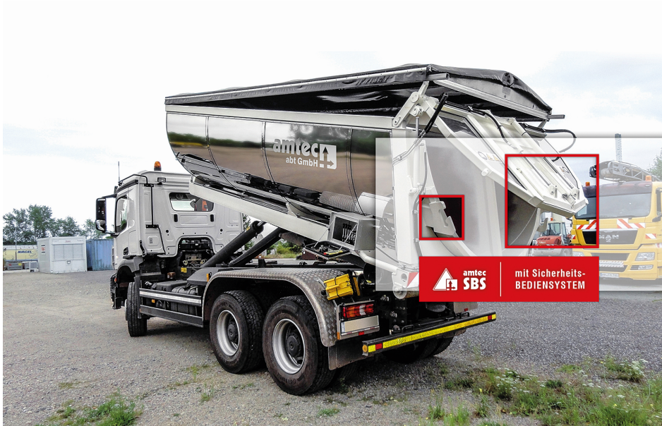
CMT Asphaltmodule auf Abrollrahmen mit SBS Sicherheitsbediensystem (amtec-abt).
