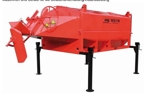
Ein BTC Birnenbehälter auf Absetzwinden mit ansteigender Auslaufmulde. Dadurch erhöht sich die Auslaufhöhe von 0,50 m. Rechts ein Thermo-Container dessen Einfüllklappen durch einen Federspeicher unterstützt werden, so dass diese auch einhändig zu betätigen sind (Engl).
