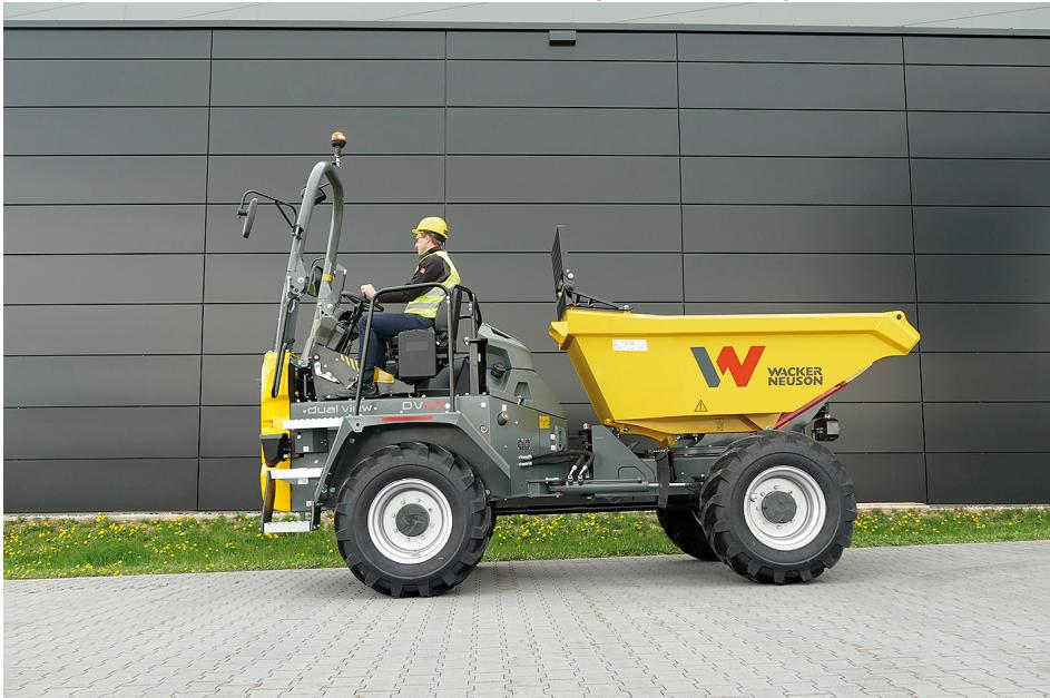
Freie Sicht in jede Richtung: Die Wacker Neuson Dual View Dumper können die Sitzposition um 180 Grad drehen.
