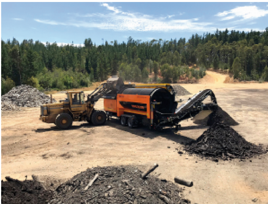
Pronar Trommelsieb MPB 20.55 mit Zentralschmieranlage und regelbarer Bandgeschwindigkeit (Jürgen Kölsch GmbH).
