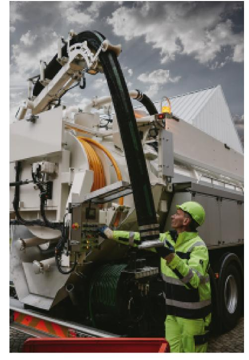
Das Saug- und Spülfahrzeug besitzt eine pneumatisch verschiebbare Trennwand, die den Frisch- und Schmutzwasserbereich des Tanks flexibel aufteilen kann.
