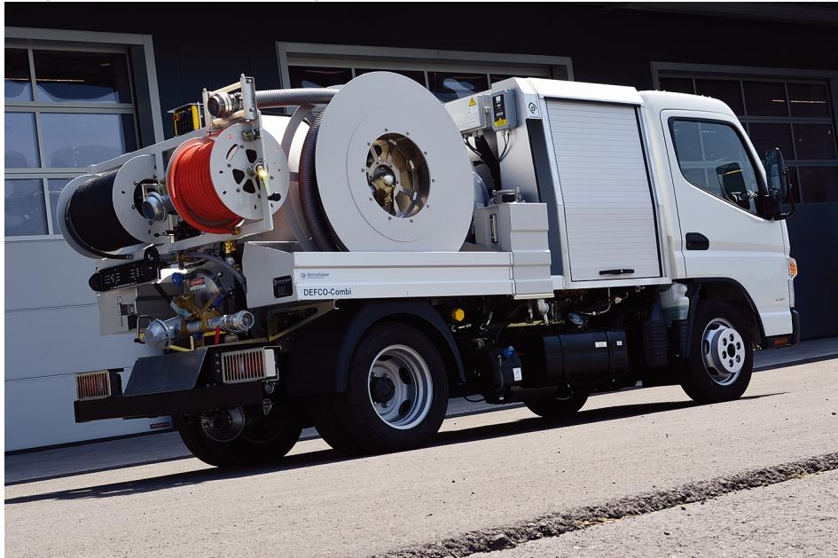
Der Defco Combi 3,5 t wird in Zukunft auf dem kompakten Fuso Canter 3515 aufgebaut (Dietmar Kaiser).
