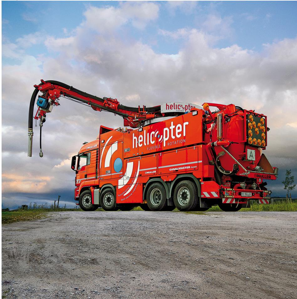
Der Canalmaster von Müller Umwelttechnik mit Helicopter-Ausleger Heli 360-6-Tandem und Wasseraufbereitung.
