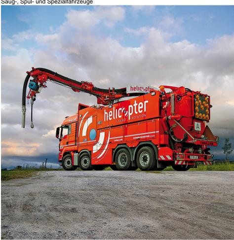
Der Canalmaster von Müller Umwelttechnik mit Helicopter-Ausleger Heli 360-6-Tandem und Wasseraufbereitung.
