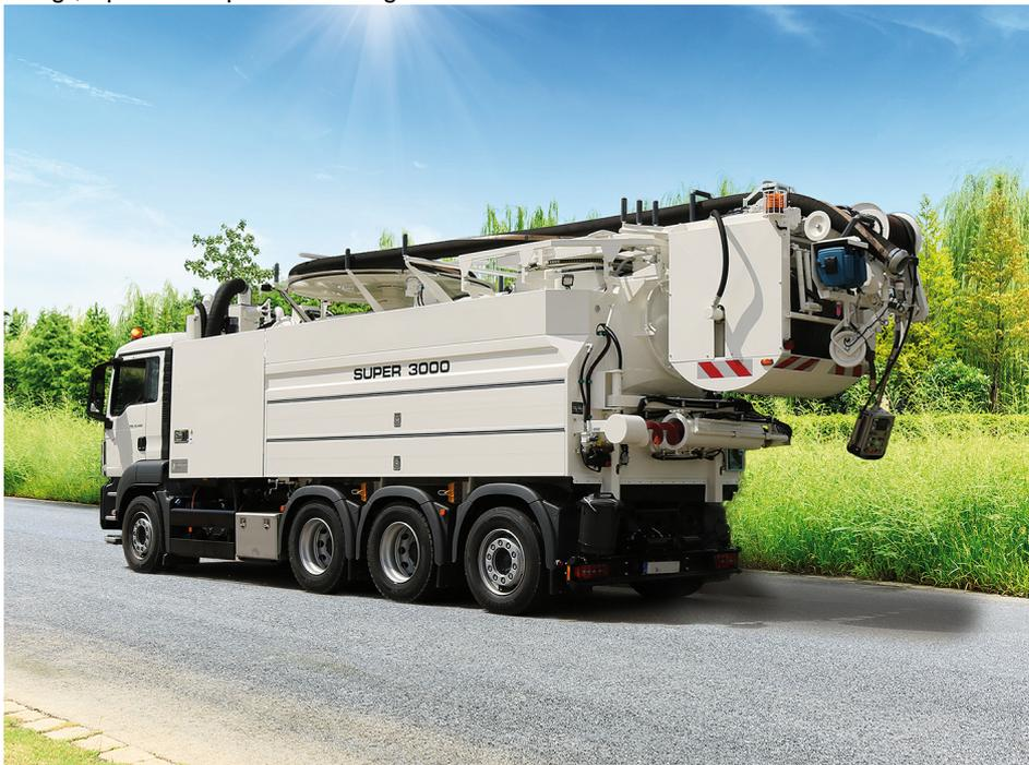
Der Sauger 3000 brennt nicht nur mineralische und organische Stoffe, sondern ermöglicht mittels Schneckenentleerung eine Entsorgung direkt am Einsatzort in einen Container (WQiedemann enviro tec).
