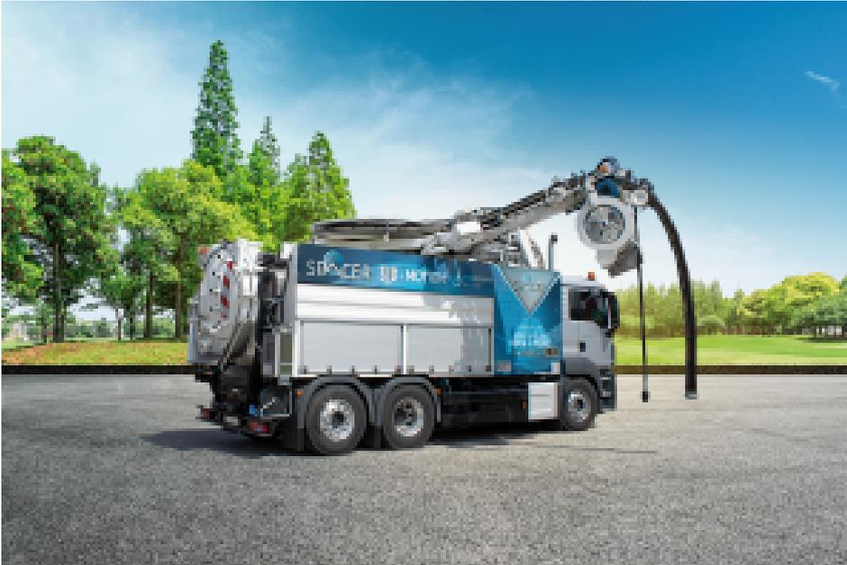
Mit seinem neuen bis zu 270° schwenkbaren Auslegersystem Spacer bietet der Super 2000 größte Beweglichkeit bei einem Arbeitsradius von 6,7 m (Wiedemann enviro tec).
