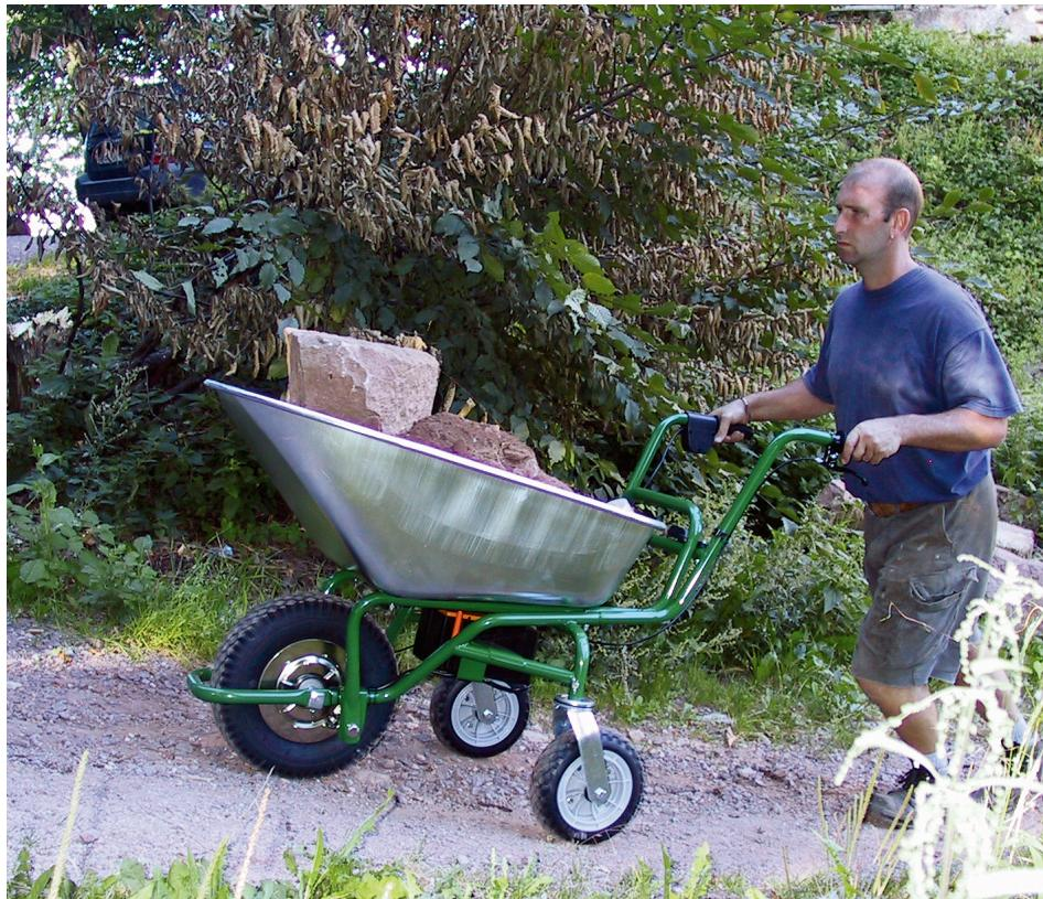
Der Elektroschubkarren Donkey (Ebinger) ist bis zu 3,5 km/h schnell und erlaubt eine maximale Zuladung von 120 kg.
