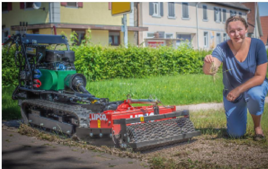
Das Gerät für wassergebundene Flächen und Wege kann neben dem Dreipunkt-Heckenanbau für andere Hersteller auch in Verbindung mit den Geräteträgern von Lipco eingesetzt werden.
