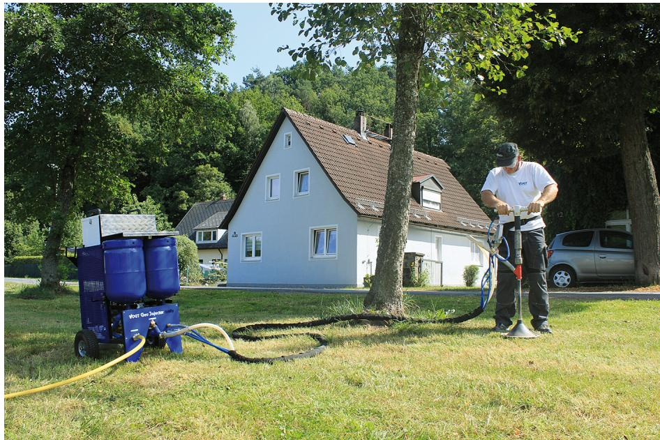
VOGT Gep Injector trolley ist ein Kombigerät aus Dosier- und Bevorratungswagen. Über den TurboSpaten wird der Boden per Druckluft belüftet, verfüllt oder gleichzeitig Bodenhilfsstoffe eingebracht.
