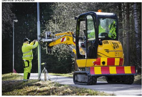
Das Roch-Services-Verfahren bietet eine nachhaltige und sichere Standsicherheitsprüfung von stehend verankerten Systemen wie z. B. Ampeln, Laternen und Masten. Eine Vorrichtung überzeugt über eine Krafteinleitung ein stetig steigendes Biegemoment im Mast.
