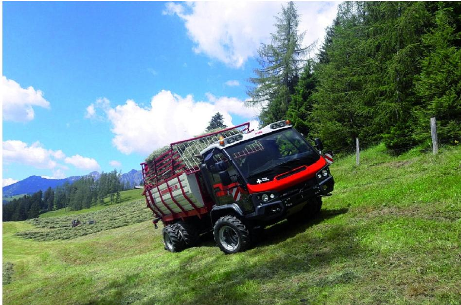
Im Stile eines Offroaders: Stufenloser Fahrantrieb und kräftiger Turbodiesel (109 PS) empfehlen den VT 450 für Spezialeinsätze.
