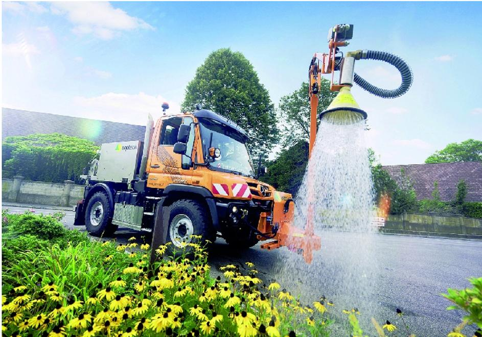
Mercedes-Benz Unimog U 218. Ausgerüstet mit einem Gießarm der Firma Ecotech mit einer Reichweite von bis zu 6,3 Metern sorgt er für rasche und wirkungsvolle Bewässerung.
