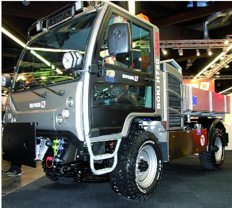
Im Kern ein Bokimobil, unter der Regie von Reform aber weiterentwickelt: Boki 1152, auch mit hydrostatischem Antrieb lieferbar.
