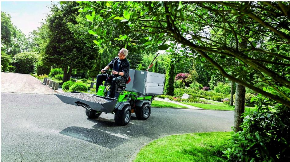
Ideal für beengte Räume: Der Park Ranger 2250 ist mit einem Wenderadius von gerade einmal 1,5 m und 485 kg Gewicht die perfekte Maschine für Arbeiten in Grünanlagen (Bild: Egholm).
