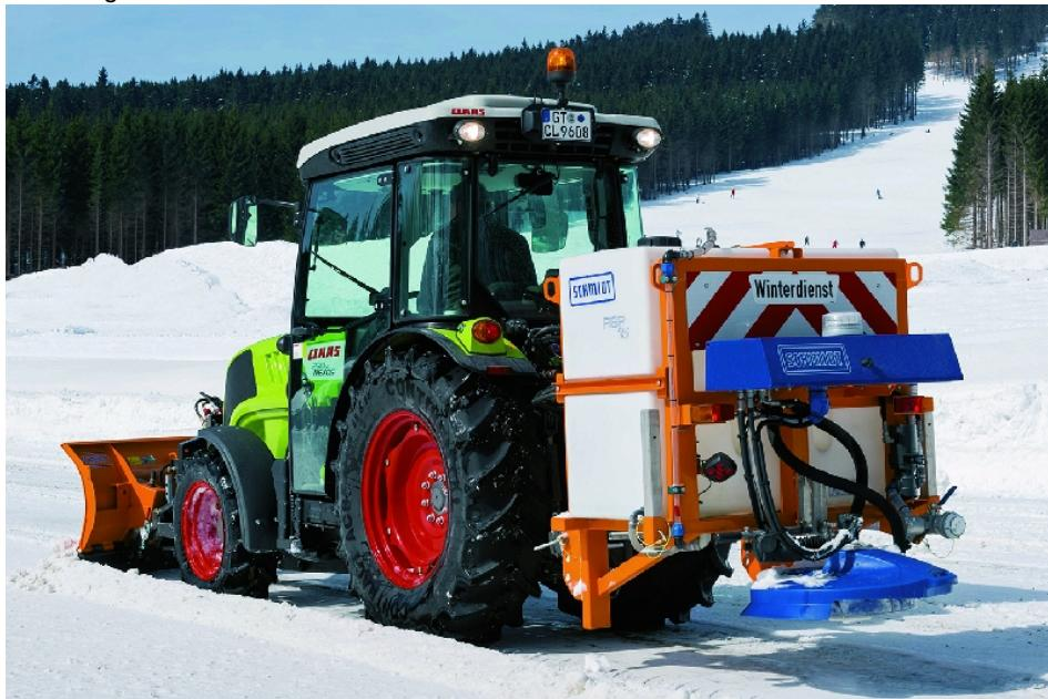
Der Schmalspur Traktor NEXOS von Claas bietet drei Hydraulikpumpen. Hier mit Winterdiensttechnik von Aebi Schmidt.
