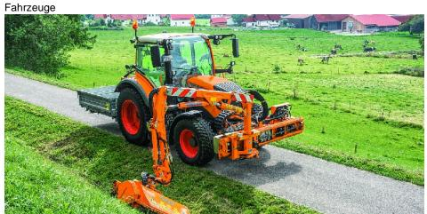
Für die Kompaktklasse erfunden: Der Vario 311 lässt sich bei Bedarf mit diversen Anbaugeräten ausstatten – wie hier mit einem Mähwerk-Frontausleger.
