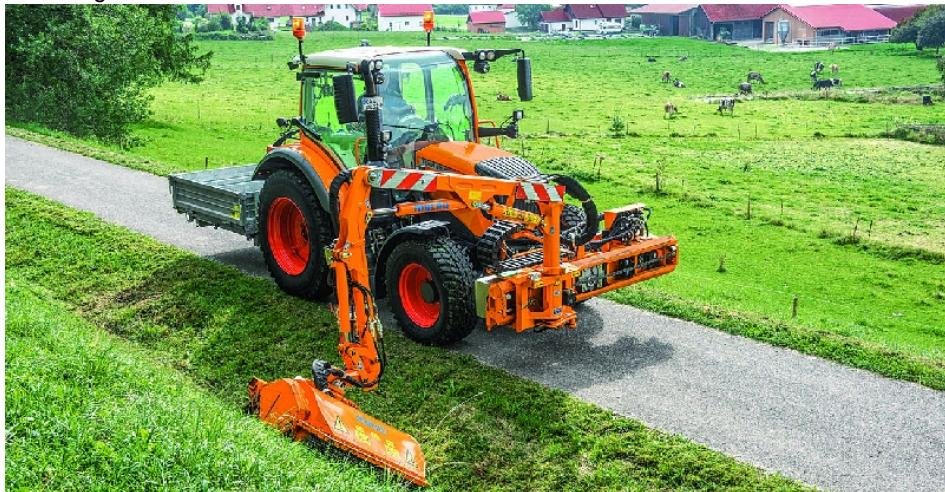
Für die Kompaktklasse erfunden: Der Vario 311 lässt sich bei Bedarf mit diversen Anbaugeräten ausstatten – wie hier mit einem Mähwerk-Frontausleger.
