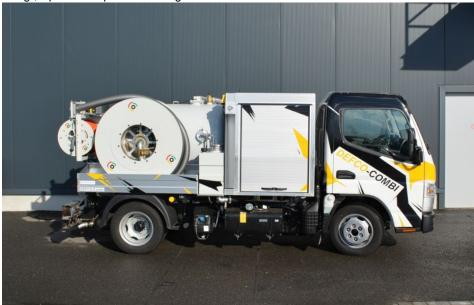
Der »Defco-Combi « 3,5 t wird auf dem kompakten Fuso Canter aufgebaut (Bild: Dietmar Kaiser).
