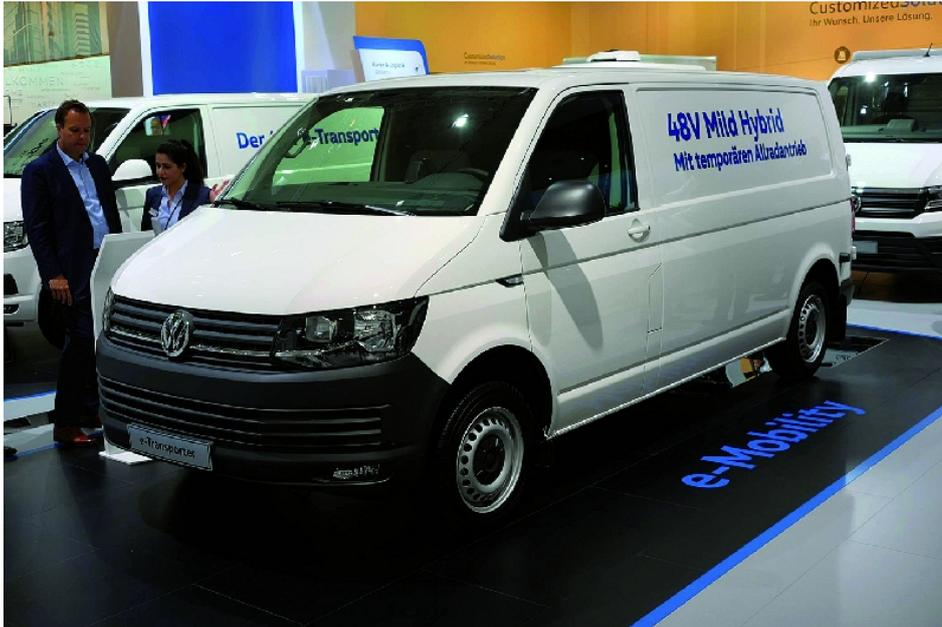
In Zusammenarbeit mit dem Engineeringdienstleister Dirks aus Emden hat VW-Nutzfahrzeuge einen Transporter T6 mit 48-Volt-Mild-Hybrid-Antrieb ausgerüstet.
