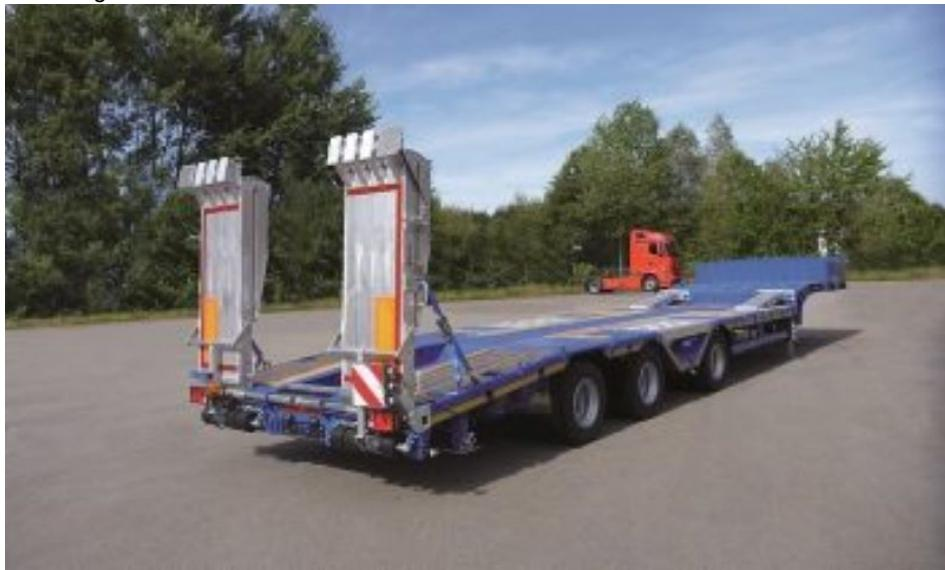
Aluminium-Verladeschienen Typ »VFR« von Altec. Durch die Verwendung von Profilbausätzen sind Tragkräfte bis 60 t zu erreichen.
