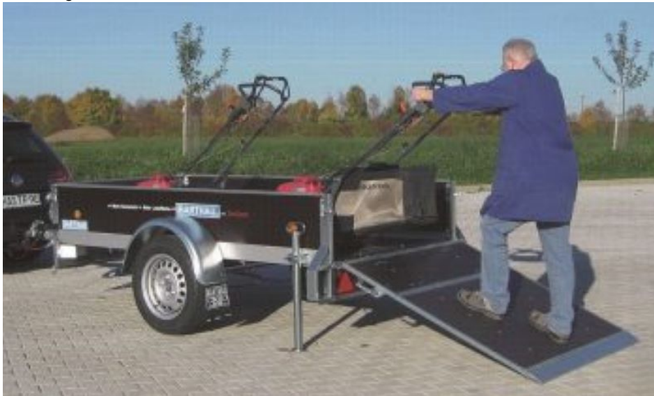
Pkw-Gewerbe-Anhänger mit steckbarer Laderampe.
