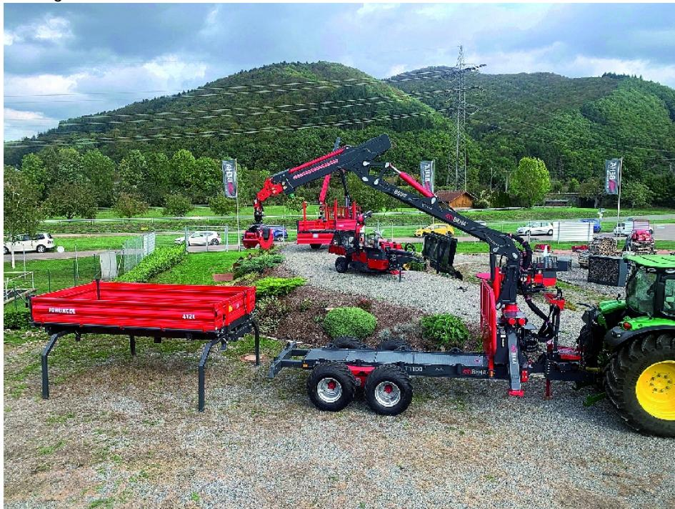
Ein Kipper, den es in zwei Varianten gibt: Zum einen mit Kran und zum anderen als Aufsatzkipper für Rückewagen (Bild: Beha Bau- und Forsttechnik).
