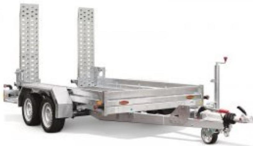
Die neuen Böckmann-Baumaschinentransporter sind wahlweise mit festen, klappbaren oder mit unterschiebbaren Auffahrtschienen ausgestattet.
