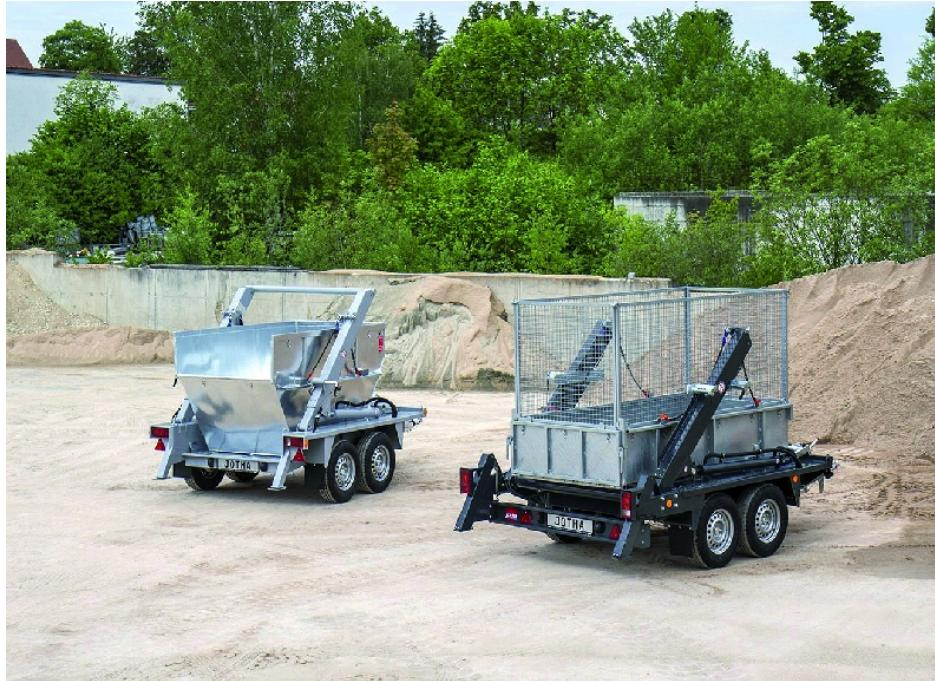
Die Schüttgutcontainer fassen bis zu 3 m<sup>3</sup>, der Flachbehälter lässt sich mit einem Laubgitter auf ein Volumen von 4,5 m<sup>3</sup> erweitern.
