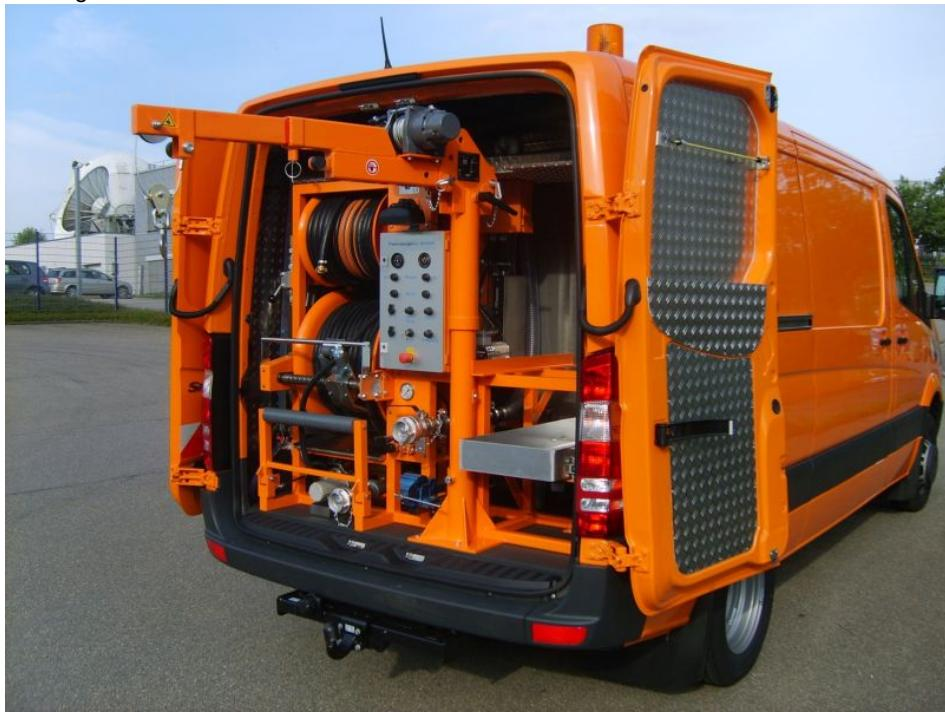
Leichter Ladekran Hummel »GSG 500« zum Einbau in Kanal-Servicefahrzeuge (Bild: ARPO).
