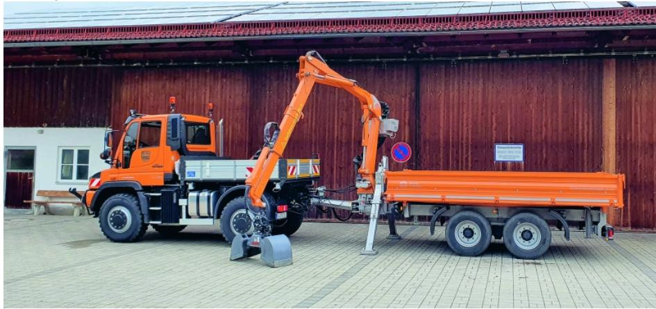
Mit einem Schwenkbereich von 370° kann auch das Zugfahrzeug mit dem Ladekran beladen werden (Bild: Schlang & Reichart).
