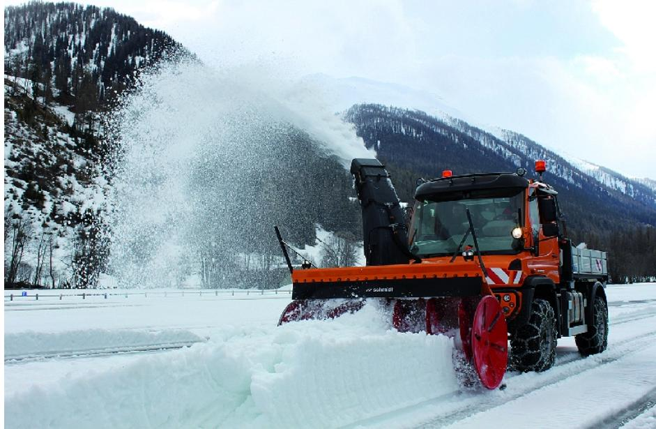
Die »FS-HP«-Anbau-Schneefrässchleudern decken durch unterschiedliche Räumleistungen und Räumbreiten eine große Palette von Anforderungen ab (Bild: Aebi Schmidt).
