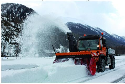
Die »FS-HP«-Anbau-Schneefrässchleudern decken durch unterschiedliche Räumleistungen und Räumbreiten eine große Palette von Anforderungen ab (Bild: Aebi Schmidt).
