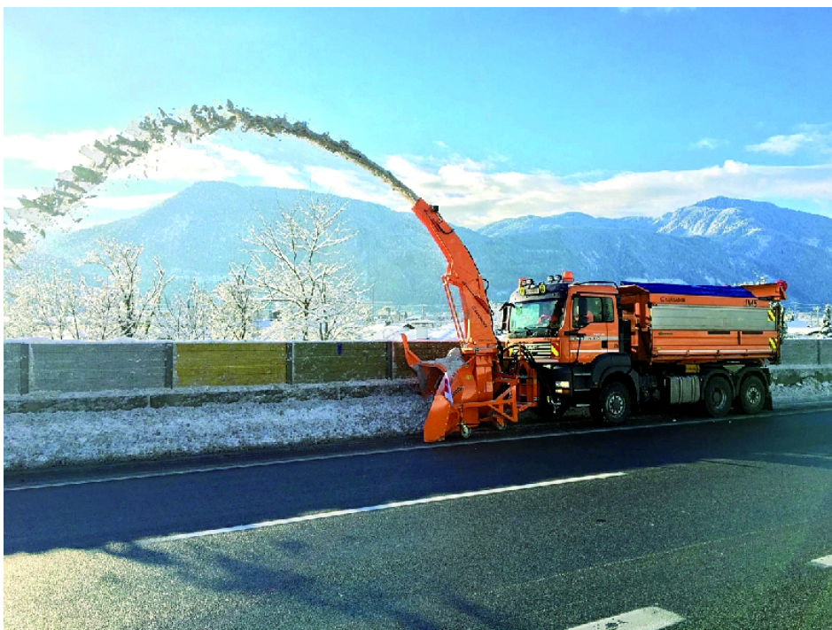
Eine Kahlbacher Seiten-Schneesleuder KSL 130 mit hydrostatischem Fahr- und Geräteantrieb im Einsatz.
