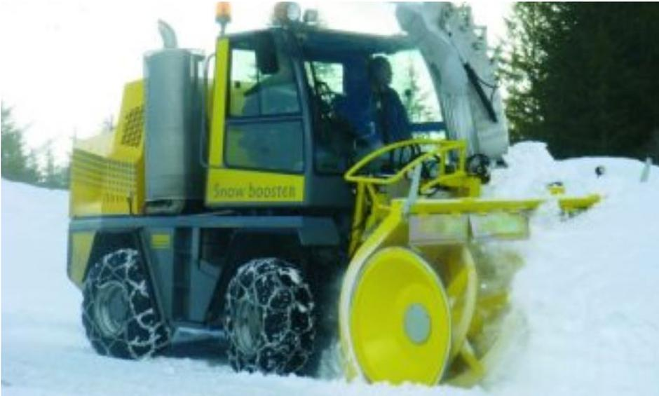
Der Boschung Snowbooster B6 ist eine leistungsstarke Schneefräse für den intensiven Winterdienst. Mit drei verfügbaren Arbeitsbreiten von 2100, 2300 und 2500 mm wird eine maximale Räumleistung von ca. 3500 t/h erreicht.
